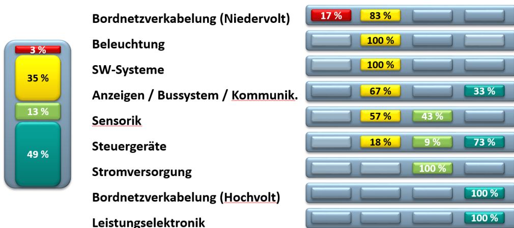
Abbildung 6: Veränderungspotentiale in der Teilestruktur von ICEV zu BEV (Elektrik/Elektronik)
